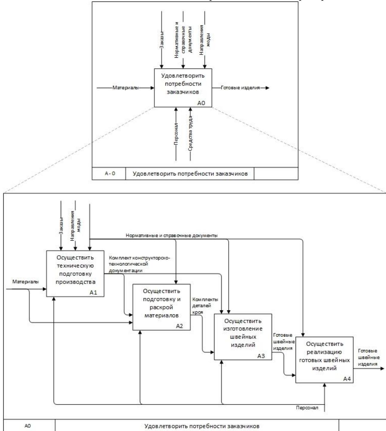
Рисунок 1 – Декомпозиция функционального блока модели IDEF0 процессов швейного предприятия
